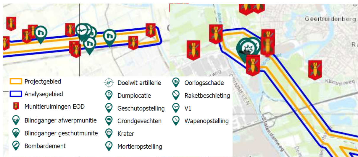
Figuur 16. Uitsnede van de inventarisatiekaart van REASeuro, met weergegeven verschillende indicaties voor de aanwezigheid van explosieven.
