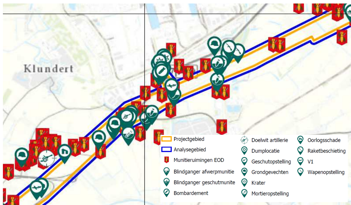
Figuur 12. Uitsnede van de inventarisatiekaart van REASeuro, met weergegeven verschillende indicaties voor de aanwezigheid van explosieven.
